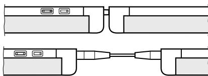
È POSSIBILE COLLEGARE IN SERIE ULTERIORI REGLETTE DELLA STESSA SERIE DIRETTAMENTE TRAMITE I CONNETTORI PRESENTI SUL CORPO DEGLI APPARECCHI O ATTRAVERSO IL CAVO DI RACCORDO IN DOTAZIONE CON CIASCUNO
